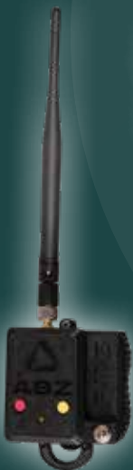
Sistema de Terminación de Vuelo
