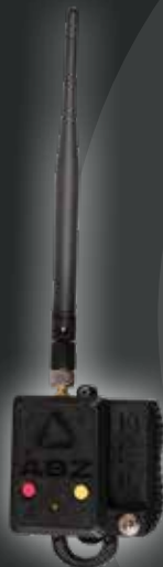
Sistema de Terminación de Vuelo
