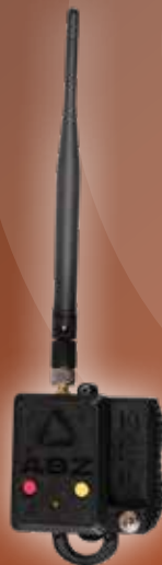
Sistema de Terminación de Vuelo
