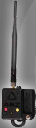
Sistema de Terminación de Vuelo
