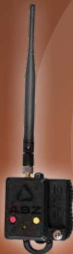
Sistema de Terminación de Vuelo
