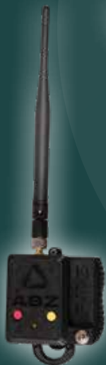
Sistema de Terminación de Vuelo
