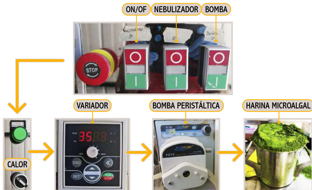
Figura 32. Procedimiento para obtener harina microalgal.
