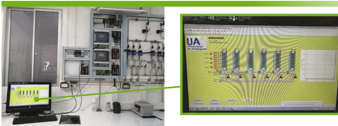
Figura 3. Implementación Sala de control automatizado de parámetros de cultivo.
