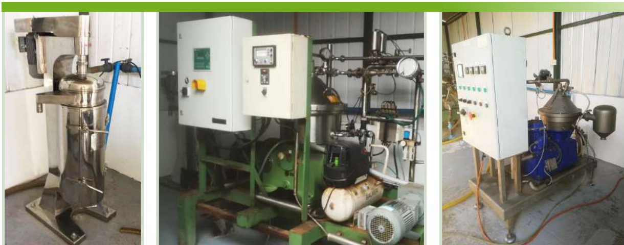
Figura 20: Fotografías de centrifugas discontinua y continuas utilizadas para el proceso de obtención de producto.
