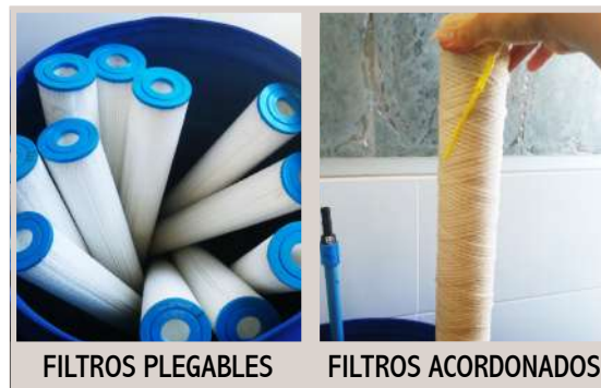
Figura 36. Filtros plegables y acordonados de 30" para el tratamiento de agua de mar.
