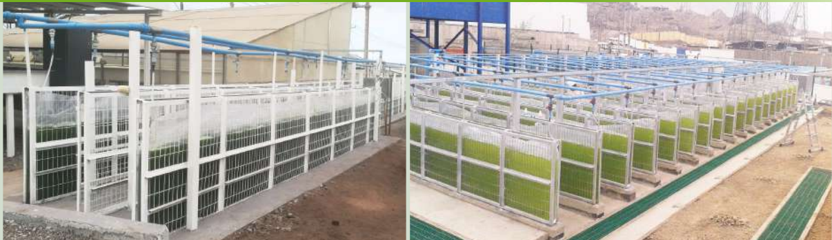
Figura 14: Fotografías de sistemas de cultivo cerrado B1000.
