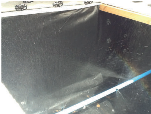
Figura 18. Vista interior de la unidad aeropónica con sistema de irrigación con microyets instalados y operativos
