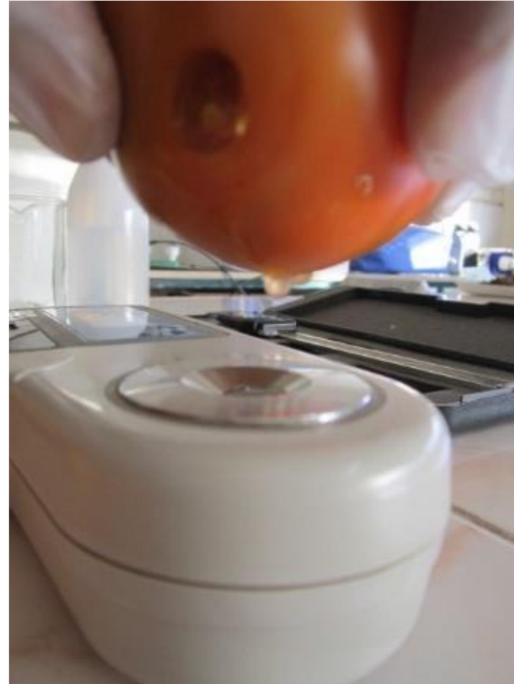
Figura 15. Evaluación de grados Brix en frutos de tomate con refractómetro digital.
