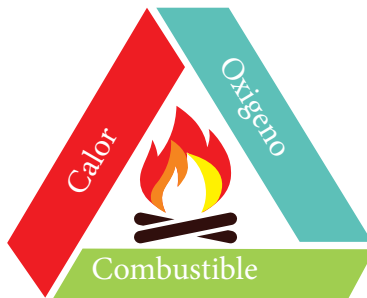
Figura 2. Triángulo del Fuego.
