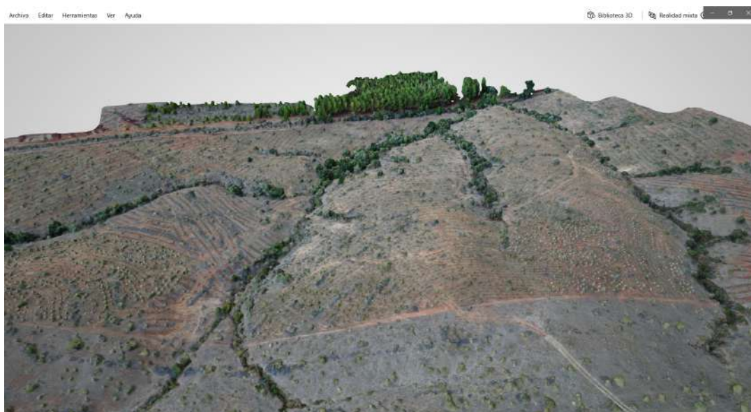
Figura 10. Representación 3D de un rodal recientemente cosechado usando imágenes provenientes de RPAS y OpenDroneMap. Fuente: CONAF (Chile).
