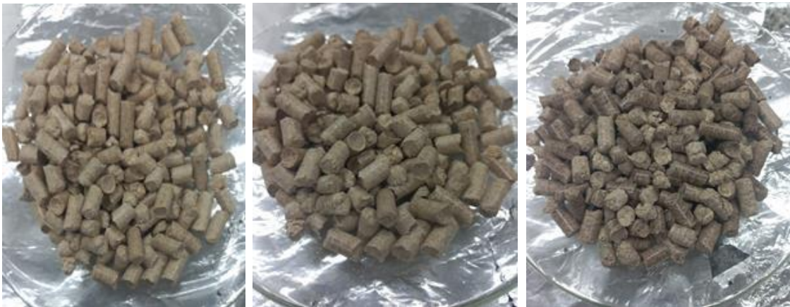
Figura N°7 PELLETS PRODUCIDO A PARTIR DE LA MEZCLA DE BIOMASAS, MEZCLAS 1, 2 Y 3
