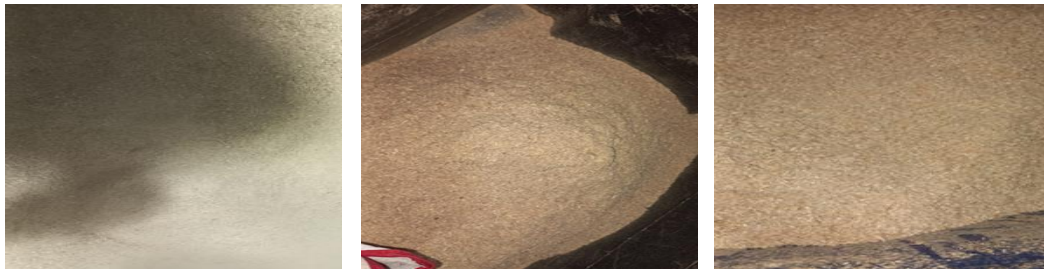
Figura N°6 BIOMASA A UN TAMAÑO FINAL DE 5 MM DE LAS MEZCLAS 1, 2 Y 3, OBTENIDAS LUEGO DEL PROCESO DE MOLIENDA
