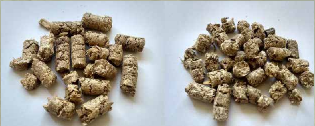
Figura N° 9 PELETS OBTENIDOS A PARTIR DE UNA BAJA HUMEDAD INICIAL DE LA MUESTRA
