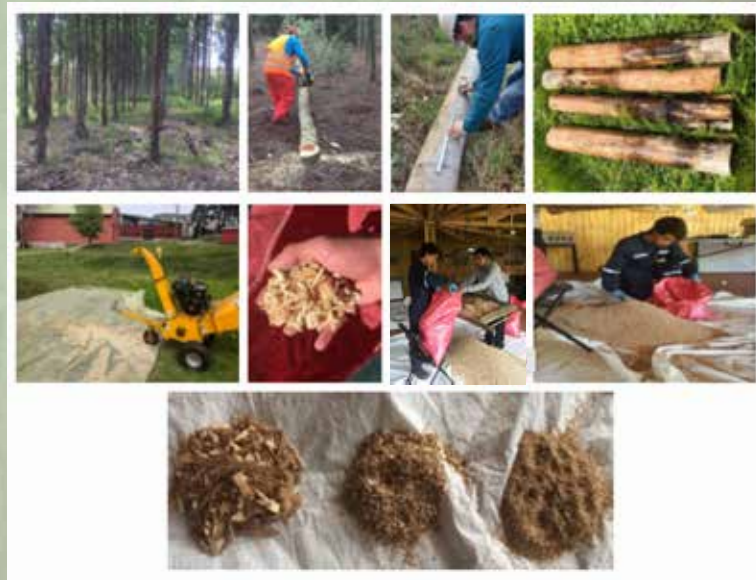
Figura N° 6 VOLTEO Y EXTRACCIÓN DE MUESTRAS, DESCORTEZADO, ASTILLADO, TAMIZADO Y BIOMASA OBTENIDA
