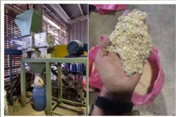
Figura N° 8 MOLIENDA DE LAS MATERIAS PRIMAS A UN TAMAÑO FINAL DE 5 mm
