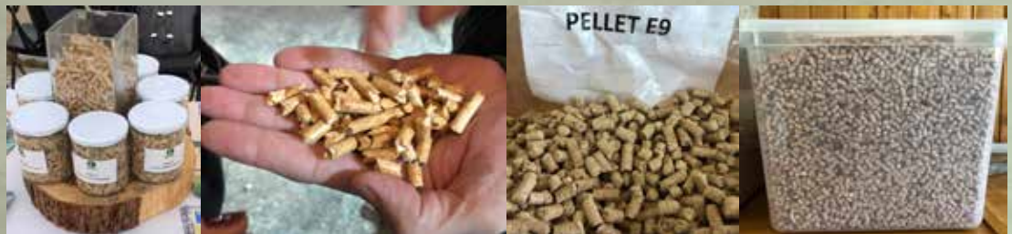
Figura N° 16 PELLET PRODUCIDO A PARTIR DE ESPECIES FORESTALES PARA SU CARACTERIZACIÓN NORMA ISO 17225-2
