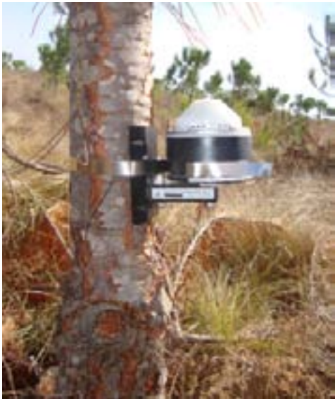
Figura 105. Dendrómetro digital instalado en Región de O'Higgins, Chile
